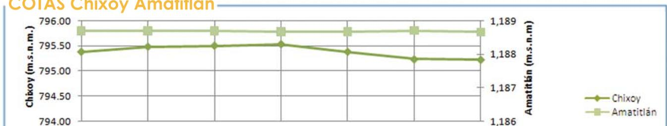
La cota de Chixoy presenta un valor de 795.38 a 795.22 m.s.n.m. con una variación de -0.16 m. La cota de Amatitlán presenta un valor de 1,188.69 a 1,188.66 m.s.n.m. con una variación de -0.03 m. Cota de rebalse de Chixoy: 803 m.s.n.m.
